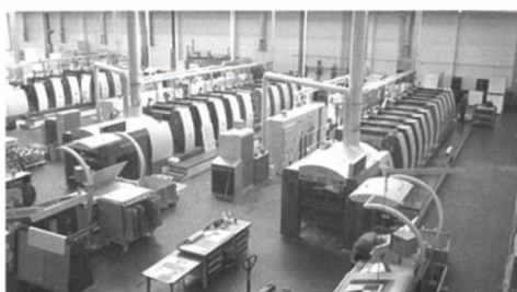
Maschinensaal mit 10-Farbenmaschinen der Firma KBA
